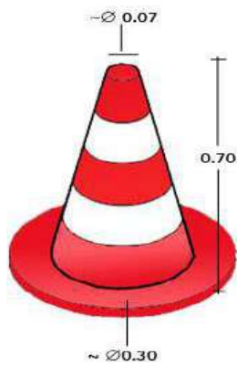
Urbanisme: senyalització plafó senyal indicatiu precaució obres
