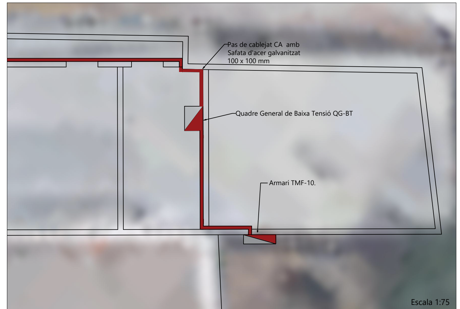
Detall 3: Instal·lació de l'inversor i quadres de proteccions.
